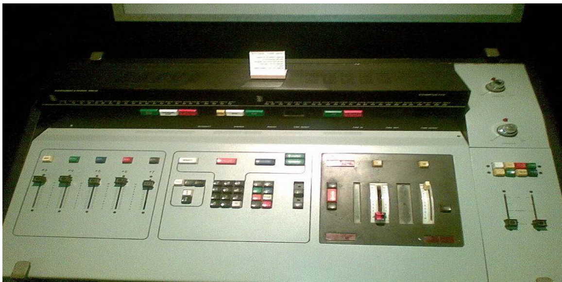
Fig.38.Compulite MC-100,primeira console a usar microprocessador ,1978
